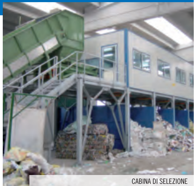
IMPIANTO DI SELEZIONE MANUALE RIFIUTI DA RACCOLTA DIFFERENZIATA
