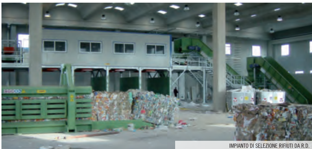
PRESSA PC 50 R SPECIFICA PER IMBALLAGGIO BOTTIGLIE IN PET
