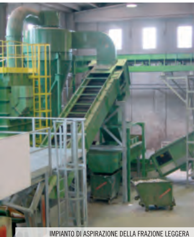
SEPARATORE AERAUICO PER LA FRAZIONE LEGGERA
