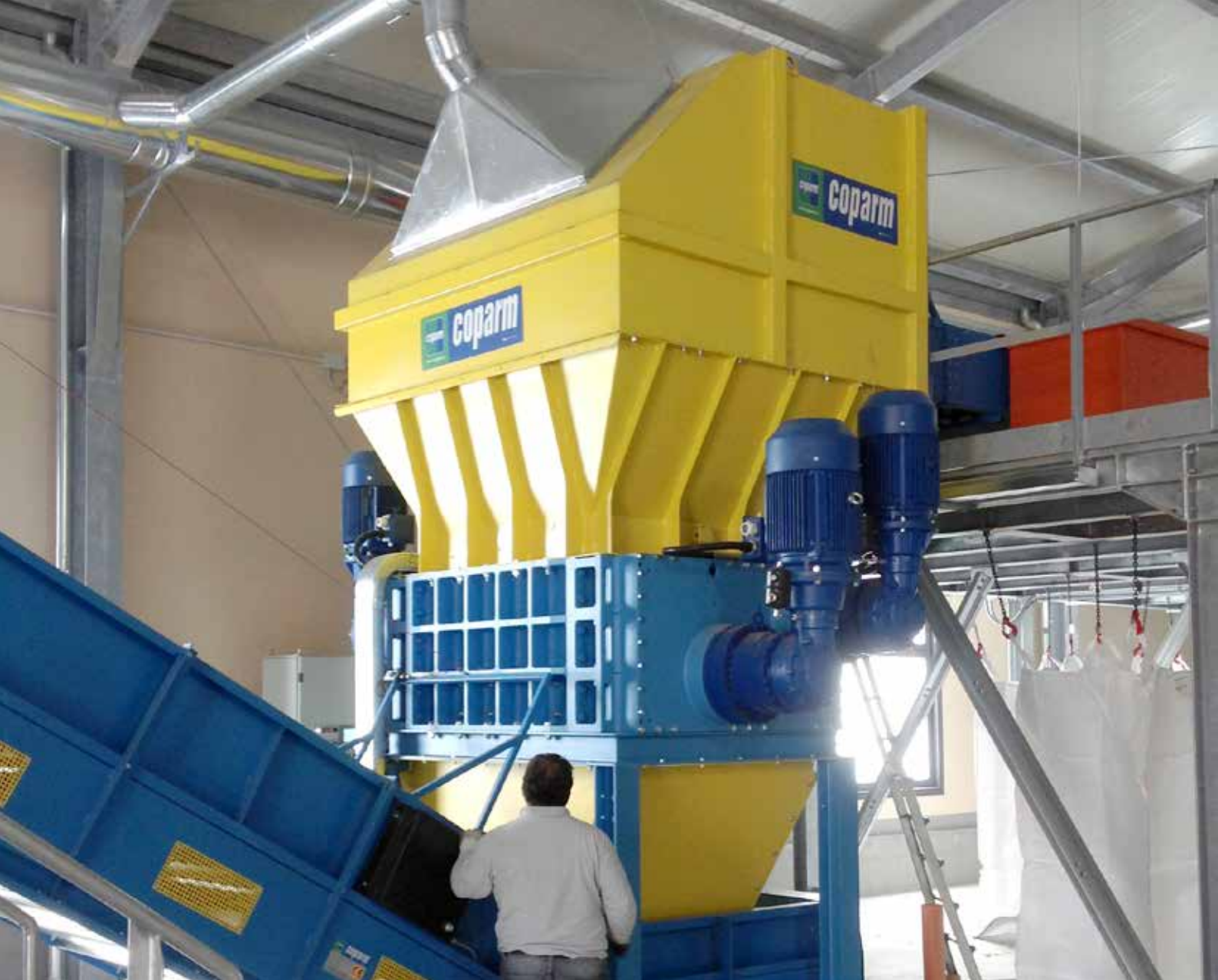
Trituratore quattro alberi - Four shafts shredder
